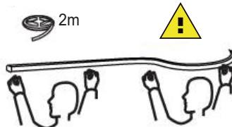
2. Utilice la herramienta para desmontar con cuidado, y no tire de la tira de LED directamente.
