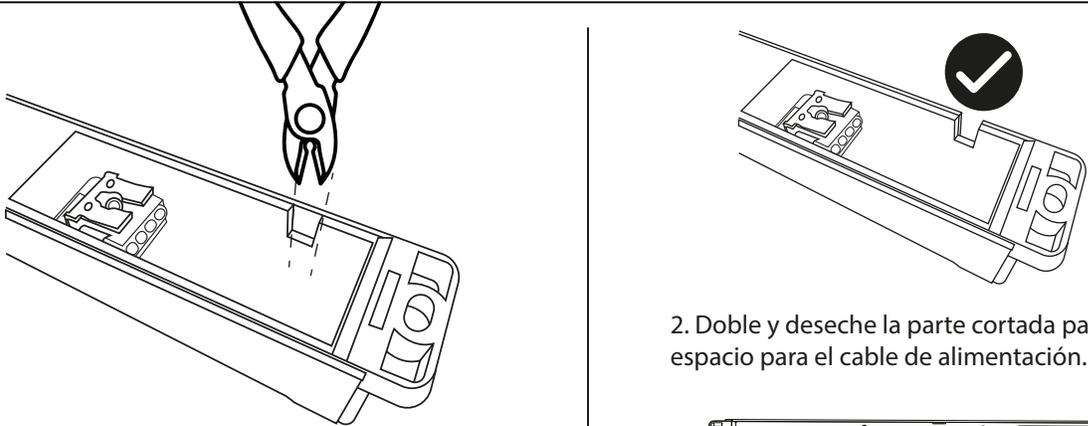
1. Antes de conectar el cable de alimentación L/N en el terminal, corte la carcasa con un alicate como se muestra en la imagen.
