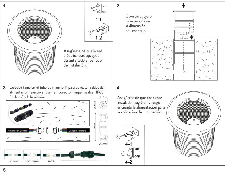
Empuje el accesorio en la funda de montaje y fije el borde a la manguita de montaje.
