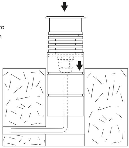
**3** Coloque también el tubo de mínimo 1" para conectar cables de alimentación eléctrica con el conector impermeable IP68 (incluido) y la luminaria.
